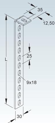
zur Befestigung der Gitterrinnen an Wänden und Decken
