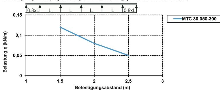
Die im Diagramm aufgeführten Belastungsangaben sind unabhängig von der Lage der Verbinder.
