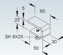
zur horizontalen Klemmbefestigung von Gitterrinnen mit mind. zwei Bodenlängsdrähten und einem mittigen Längsdrahtabstand von  $\leq 50$  mm auf Stahlträgerflansche mit einer Stärke von  $\leq 20$  mm
